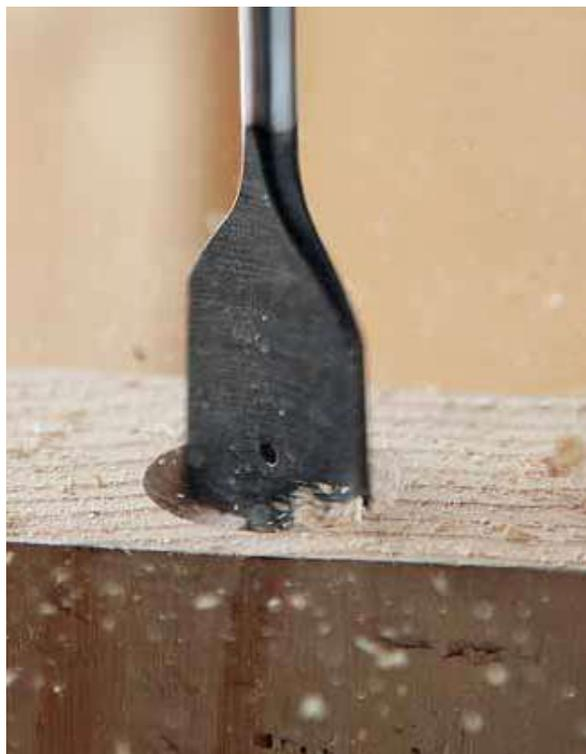
Mèche plate pour percer les bois durs et tendres, s'adapte sur perceuse ou sur visseuse avec son attachement quick-lock. La rigidité de l'axe et la pointe de centrage rectifiée permettent de réaliser des perçages rapides et propres.
